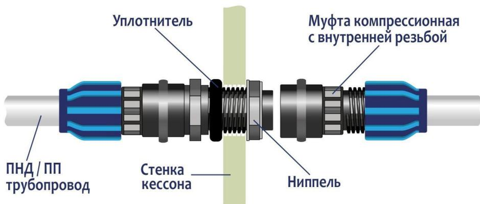
Рисунок 15. Монтаж ПНД/ПП трубопровода в пластиковый кессон
