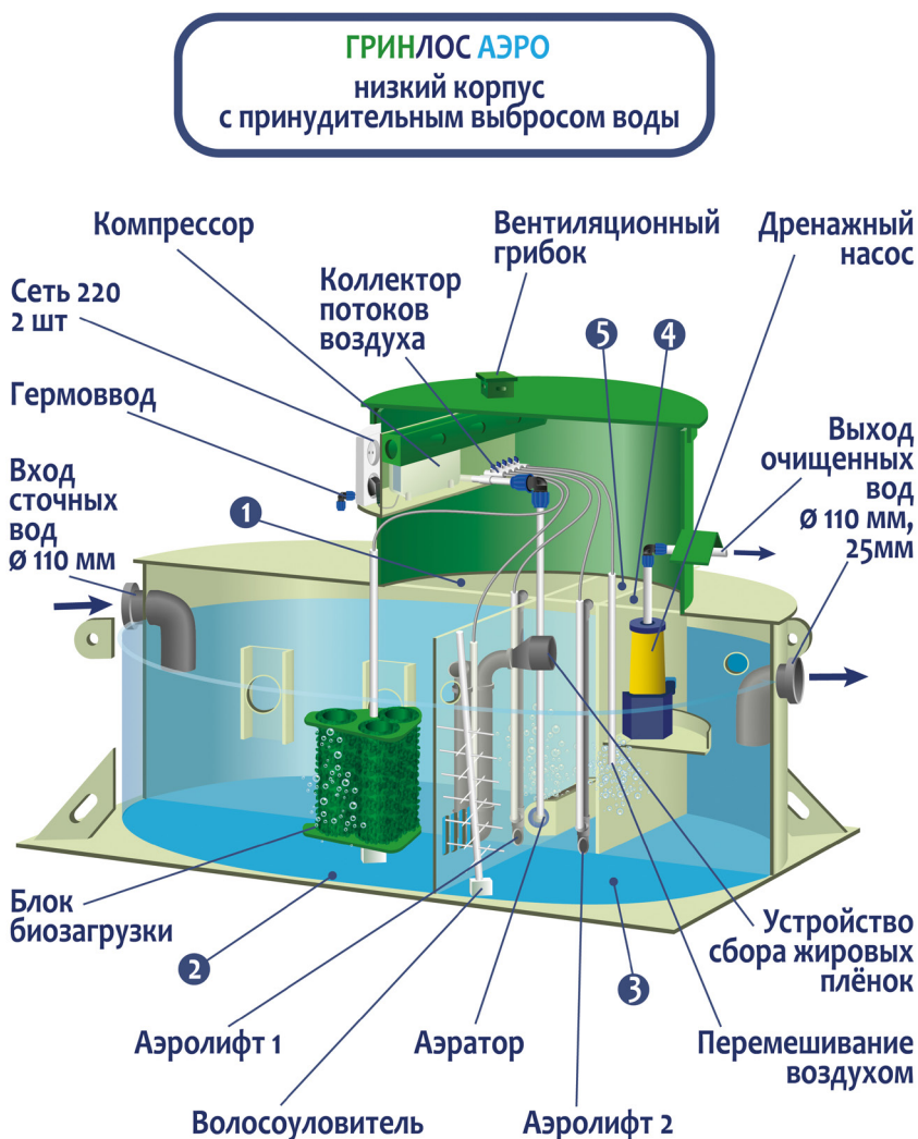
Рисунок 9. Схема Изделия ГРИНЛОС АЭРО с принудительным сбросом (низкий корпус).
