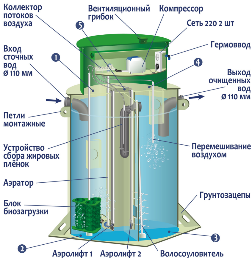
Рисунок 6. Схема Изделия ГРИНЛОС АЭРО с самотечным сбросом (стандартный корпус).
