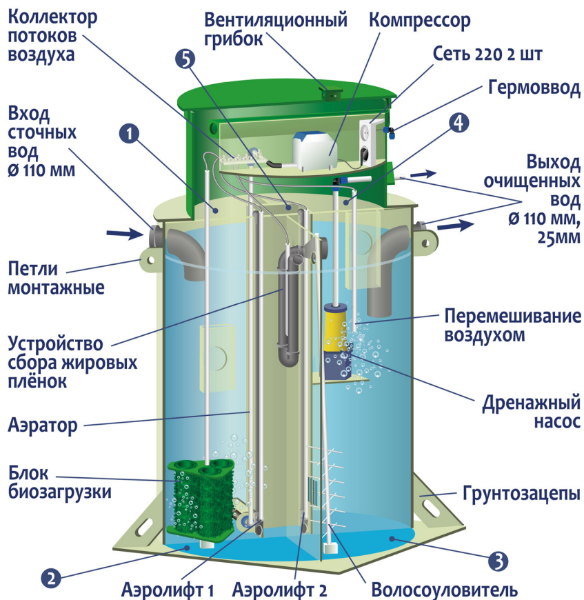
Рисунок 7. Схема Изделия ГРИНЛОС АЭРО с принудительным сбросом (стандартный корпус).
