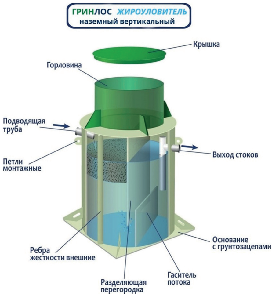
ГРИНЛОС Жироуловитель наземный вертикальный, разрез.
