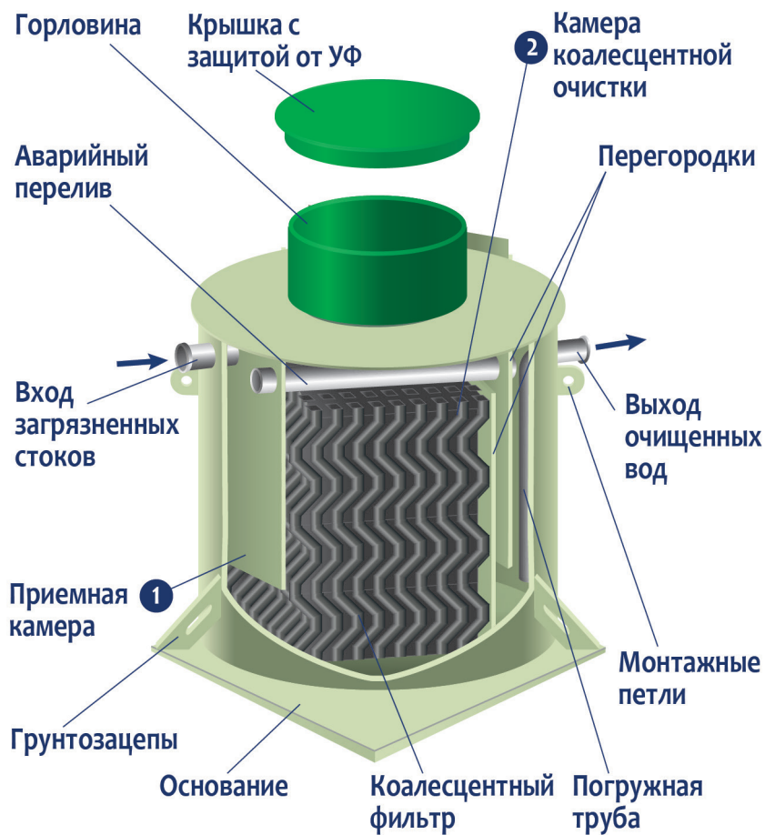
Рисунок 3. Схема изделия. ГРИНЛОС Нефтеуловитель Вертикальный.
