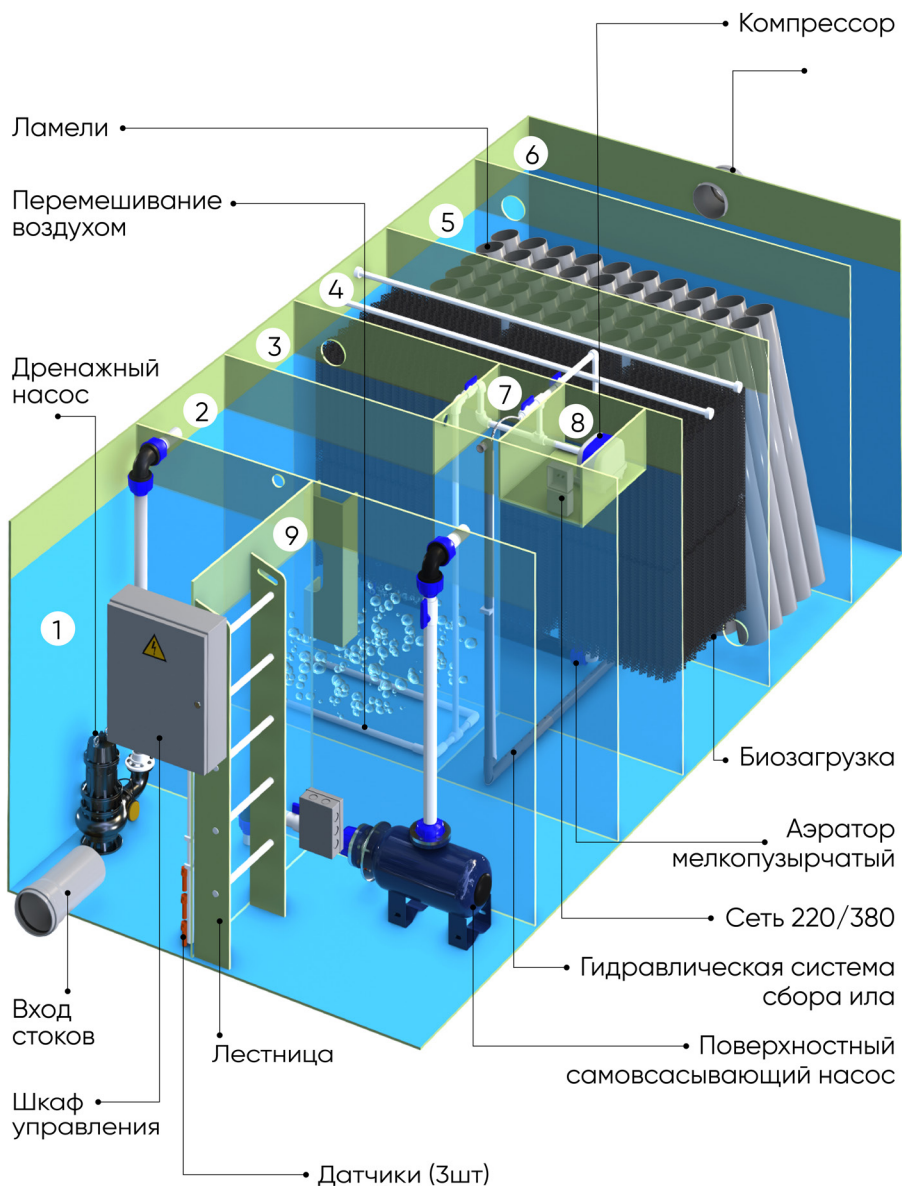
Устройство и принцип работы. Рисунок 2
